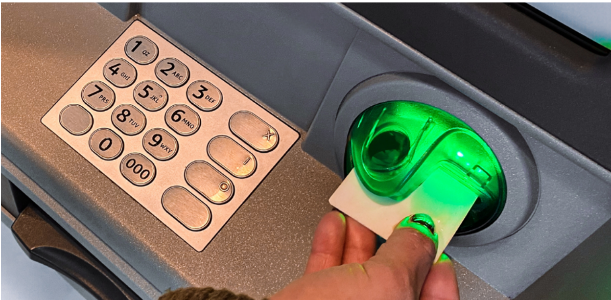
ATM automaat met anti-skim/phishing opzet
